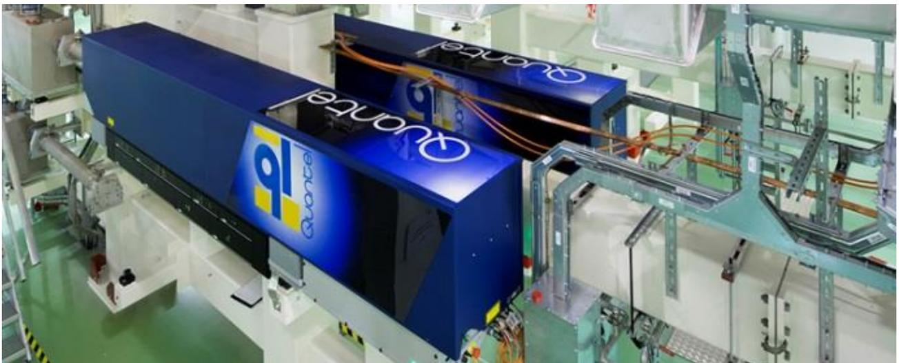
Deux modules pré-amplificateurs – laser Mégajoule
